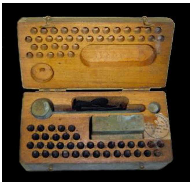
Matrice na psí známky z první světové války, ještě z kladívkem na vyklepání identifikačních znaků.
