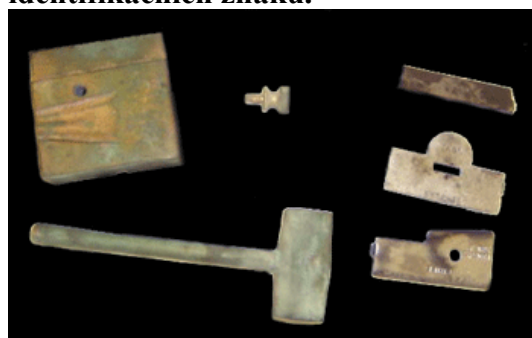
Matrice na psí známky z první světové války, ještě z kladívkem na vyklepání identifikačních znaků.
